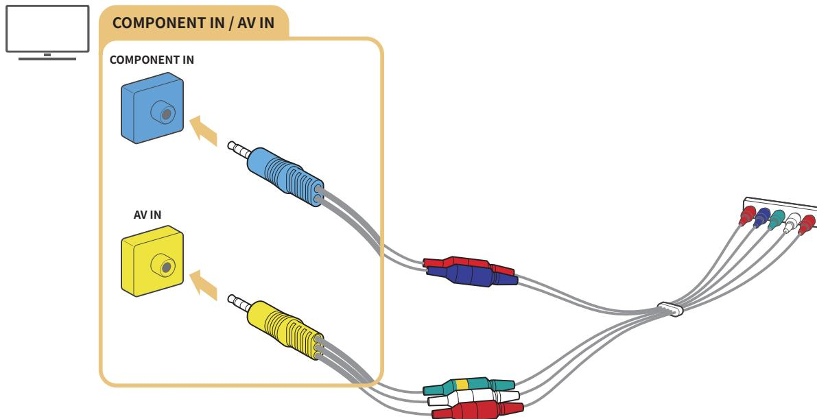
Para utilizar un equipo de componentes, conecte el adaptador de componentes (azul) y el adaptador de AV (amarillo).
