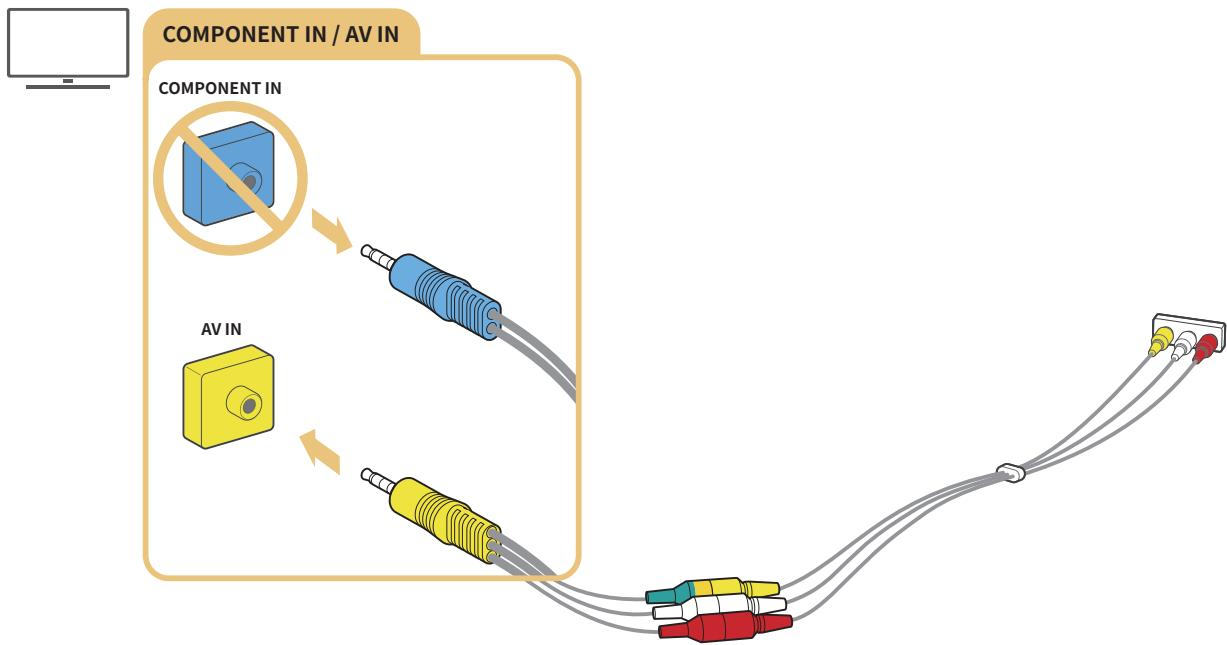
Conecte el equipo AV (compuesto) solamente a AV In. No lo conecte a Component In.
