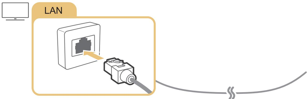
Use un cable CAT 7 (tipo \*STP) para la conexión.
