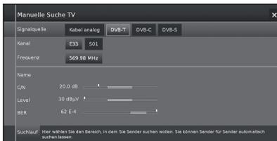
Stellen Sie die Antenne so auf bzw. richten Sie diese so aus, dass Sie die höchsten Werte für **C/N** und **Stand** erhalten.
